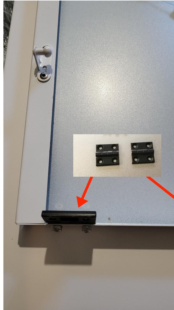
Die Scharniere an der Rückseite des Deckels werden mit den dafür vorgesehenen Schrauben verschraubt.
