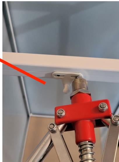
Bei den Rahmenelementen wird wie bei den Seitenwänden die Dämpferaufnahmen mit den Nieten befestigen.
