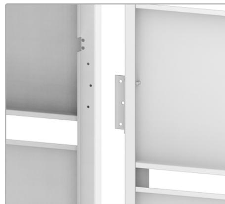
**Setzen Sie die Türscharniere auf ein vertikales Profil und verbinden Sie sie mit Schrauben (weiß verzinkt[2]).**
