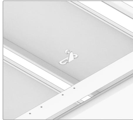
**Setzen Sie die Aufnahmen des Gasdruckdämpfers in die dafür vorgesehenen Löcher und schrauben Sie sie mit den Schrauben (schwarz[1]) fest.**
