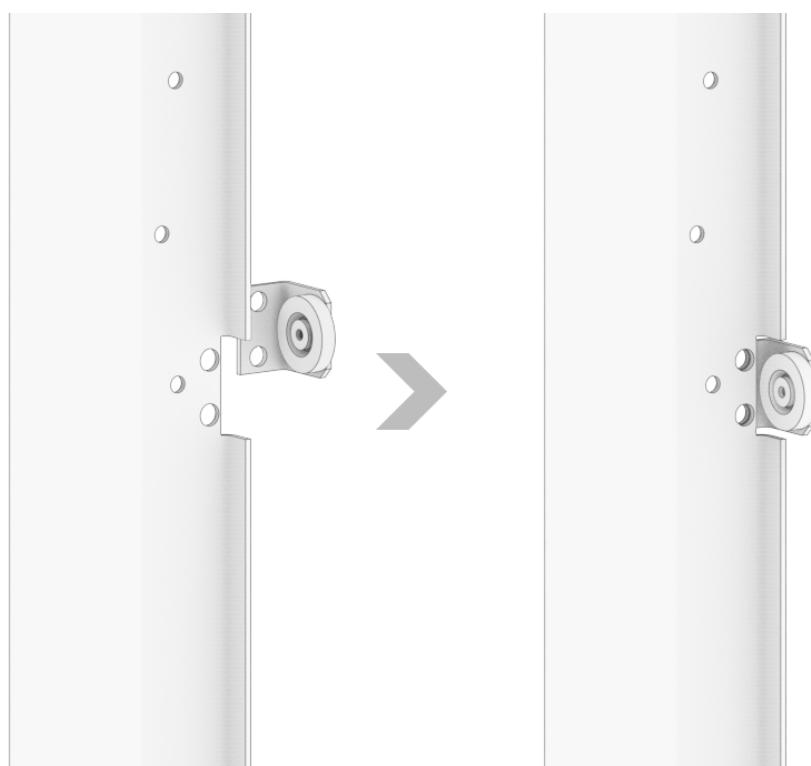
**Befestigen Sie den Winkel mit dem Magnet von innen an den vertikalen Profilen und schrauben Sie diesen mit den weiß verzinkten Schrauben fest.**
