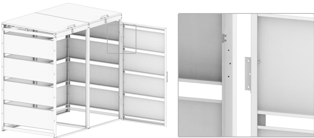
**Setzen Sie die Türscharniere auf ein vertikales Profil und verbinden Sie sie mit Schrauben (weiß verzinkt[2]).**
